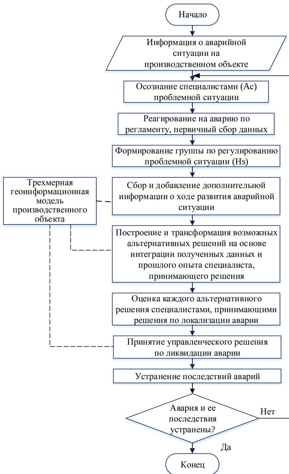
Рис.1. Алгоритм принятия управленческих решений в аварийных ситуациях на объектах телекоммуникации
